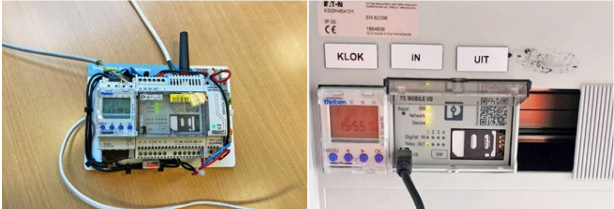
Links der Testaufbau von GSM-Relais und Zeitschaltuhr. Rechts: die eingebauten Relais und die Uhr im Bahnhof Arnhem Velperpoort.
