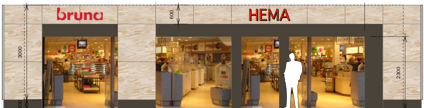
4. Afwijkend voorbeeld waarbij het geveloppervlakte voor 50 procent van het totale oppervlakte uit openingen bestaat.
